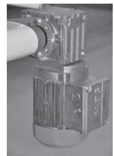
Für den Anbau an eine Trommellagerung 45 ist eine Drehmomentstütze WA 10 Art. 295040/0 erforderlich.
